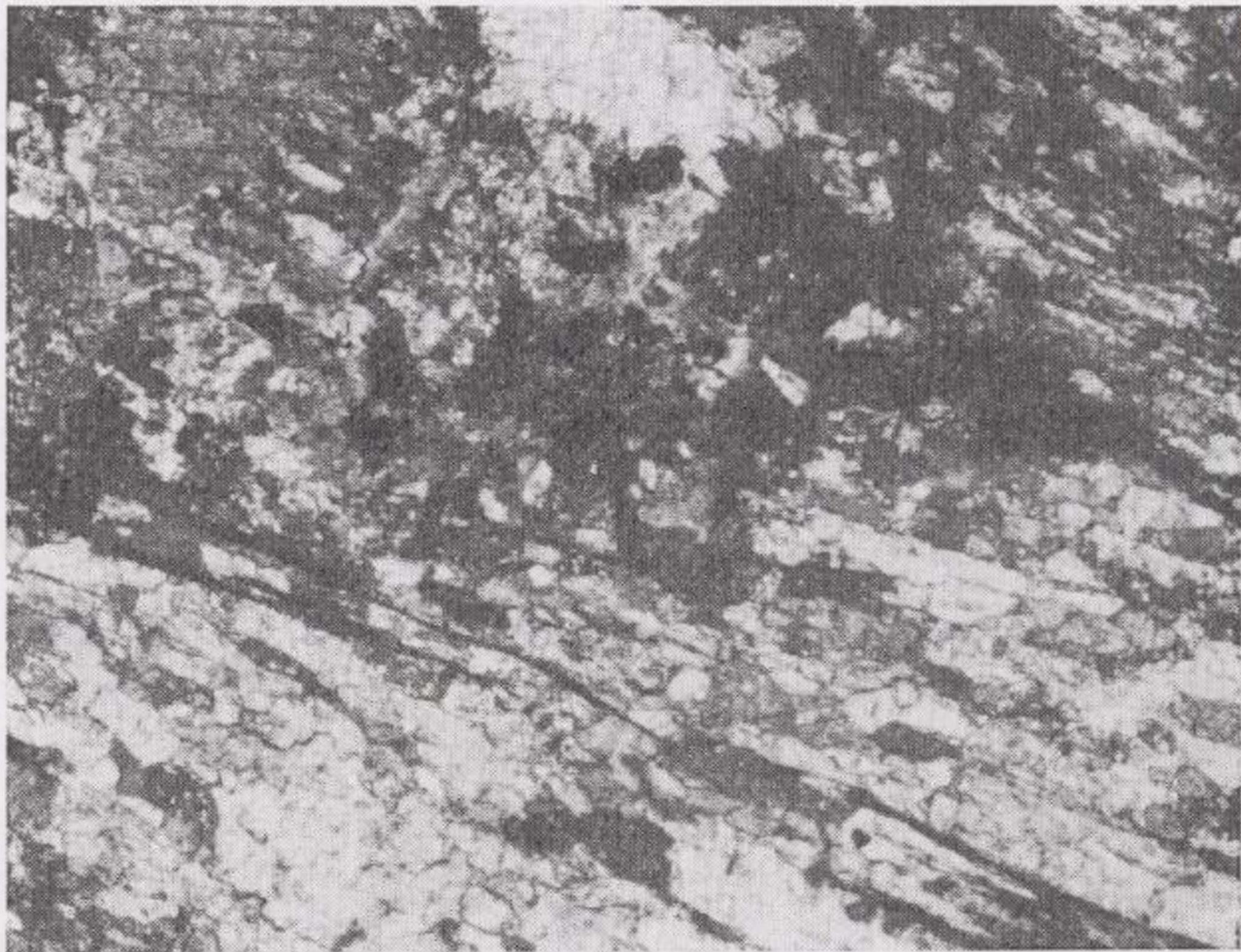
c) Calcoesquisto clorítico en tránsito a protodiabasa. Abundantes carbonatos recrystalizados y minerales cloríticos con ferromagnesianos y plagioclasas incipientes. NC × 40.
